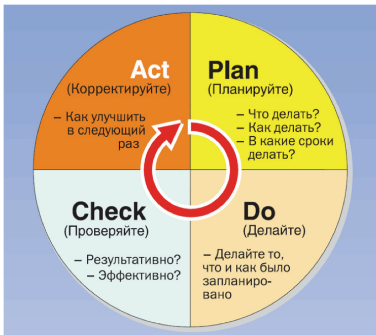
Рис. 4. Схема цикла непрерывного улучшения PDCA (Plan-Do-Check-Action), разработанная У. Демингом [Deming 2012] и У. Шухартом [Shewhart 1931].
